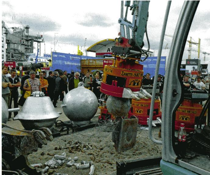
Vorführung auf der diesjährigen Bauma: ein neuer hydraulisch betriebener Elektromagnet von SAT Schwiembacher Abbruch-Technik.
